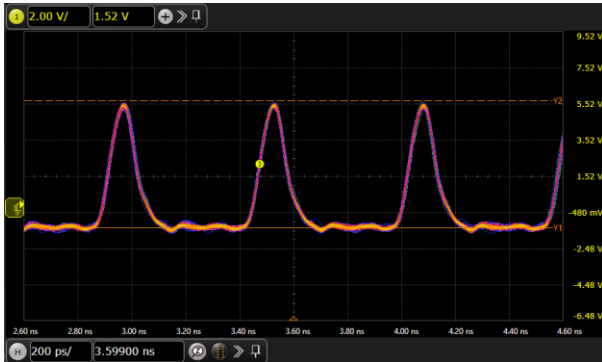
100ps pulse width @1.8GHz, 7V amplitude
